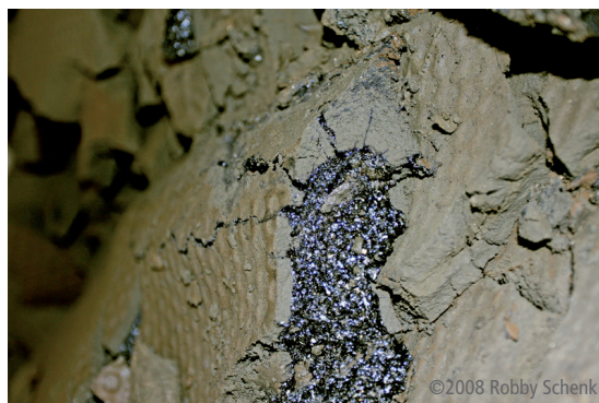
Filterkuchen mit Teereinschluss
