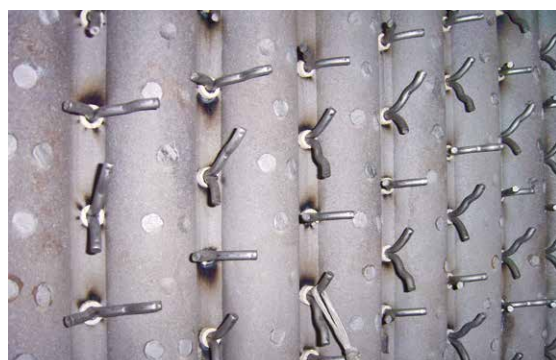
Diverse geometrieën en ankertypes en een breed scala aan materiaalcombinaties zijn lasbaar
