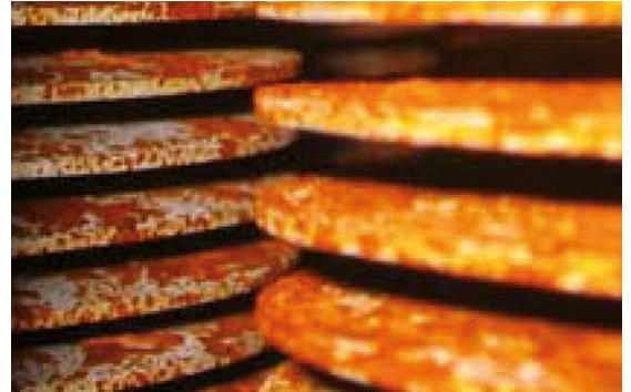
Met de natte chemische reiniging worden afzettingen ook in smalle tussenruimtes verwijderd
